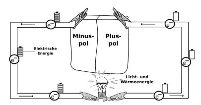
Spannungsquelle ab (in diesem Fall der Batterie). Die elektrische Spannung beschreibt die Energie pro Ladung; in unserem Fall die Energie pro freies Elektron. Die freien Elektronen strömen "mit voller Energie" aus dem Minuspol der Batterie. Wenn sie durch den Glühdraht fließen, wird die elektrische Energie der Elektronen in Licht- und Wärmeenergie umgewandelt. Dadurch fängt die Glühlampe an zu leuchten und wird heiß.
